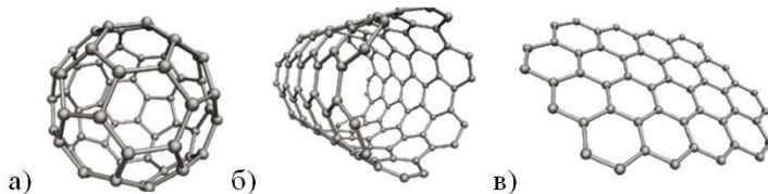
Рис. 2. Нанорозмірні алотропні модифікації вуглецю: а) фулерен, б) вуглецева нанотрубка, в) графен
